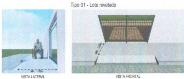
Esquema ilustrativo de possíveis ajustes de soleira das casas
