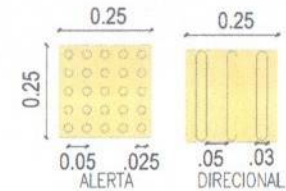
Detalhe 07 - Píso Tátil de Alerta e Direcional escala 10
